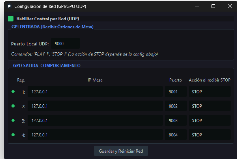
Figura 6.3: Configuración nativa de red UDP en puerto 9000
